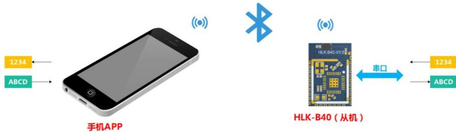
图 1 一对一蓝牙连接透传功能示意图
